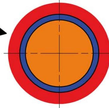
Ensemble Bio-Butteur  $\varnothing 330$  avec douille  $\varnothing 30.3$
